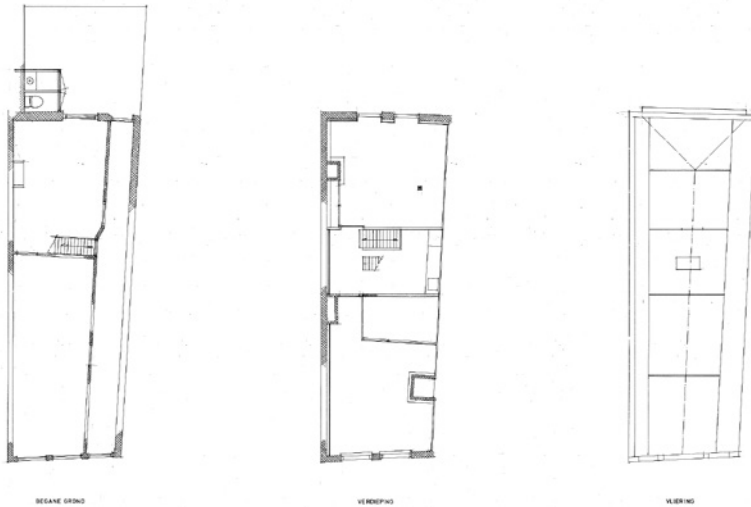
Bouwtekening: de toestand vóór de restauratie
